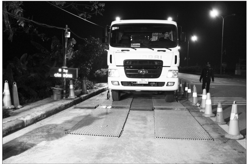
Cân kiểm tra tải trọng xe tại Trạm Kiểm soát tải trọng xe lưu động, Quốc lộ 21, xã Nghĩa An (Nam Trực).
